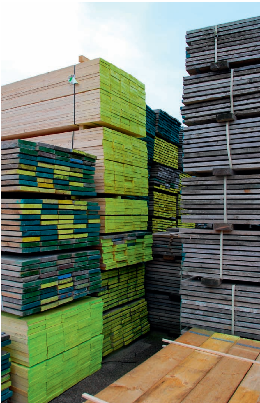
Opslag van steigerplanken
